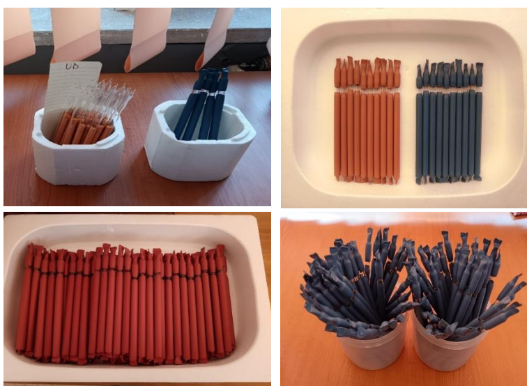
Figura 34. Fiole sigilate cu tuburi termocontractabile roșii și albastre
