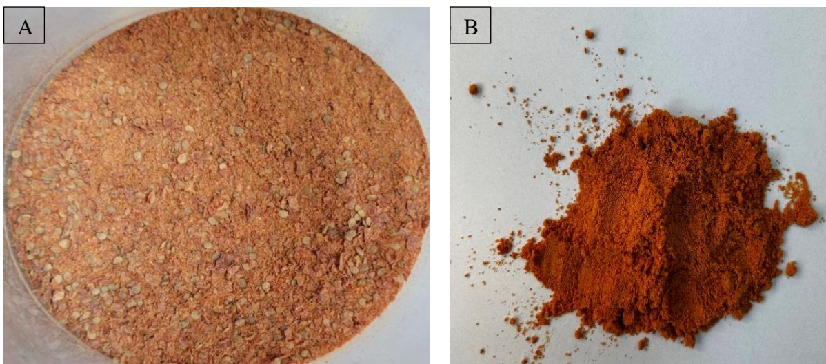
Figura 9. A) Mărunțirea inițială a masei uscate B) Măcinarea masei uscate cu moara de laborator
