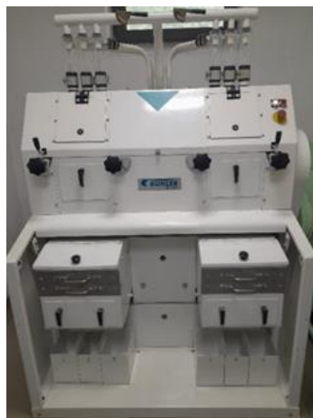
Fig. 4.2. Moară de laborator Bühler MLU 202, Bühler Group, Uzwil, Elveția. Vedere generală
